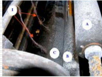
上膠處靜電消除線之接法
