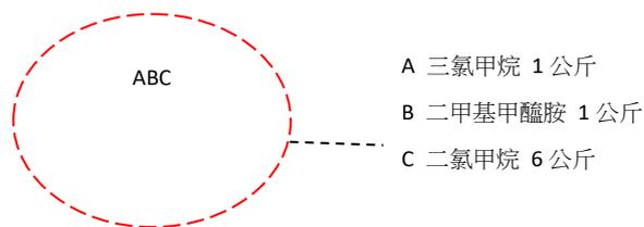
(6)若實驗桌有放置"分裝"貯存之毒化物時，在內部配置圖上註明貯存毒化物之代號、名稱、最大存量(公斤)。(如 P6 例圖之圈選及標示處)
