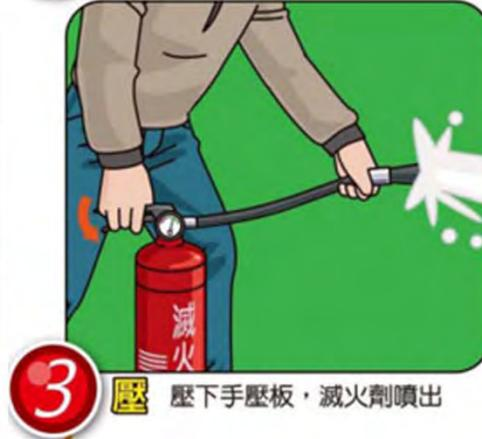
**3 壓** 壓下手壓板，滅火劑噴出
