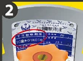
合格標示遭塗改、污損
